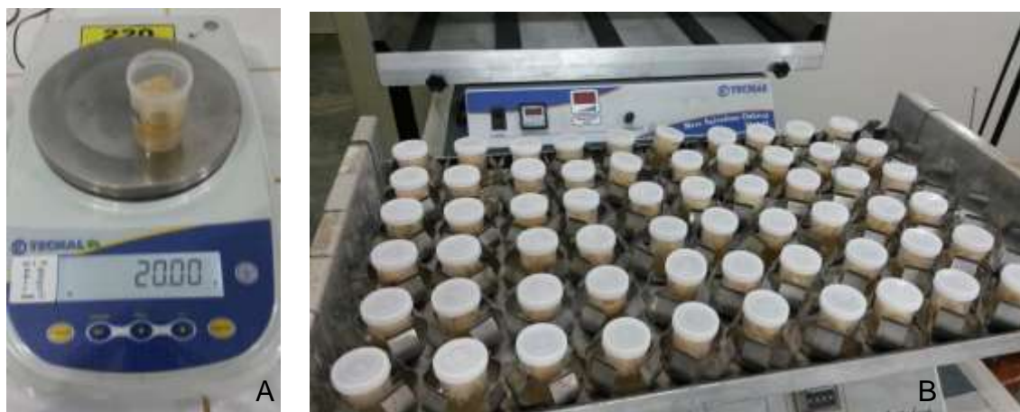
Figura 4. Determinação de nitrogênio amoniacal volatilizado. A – Adição de água destilada. B – Homogeneização em agitador horizontal a 220 rpm.
